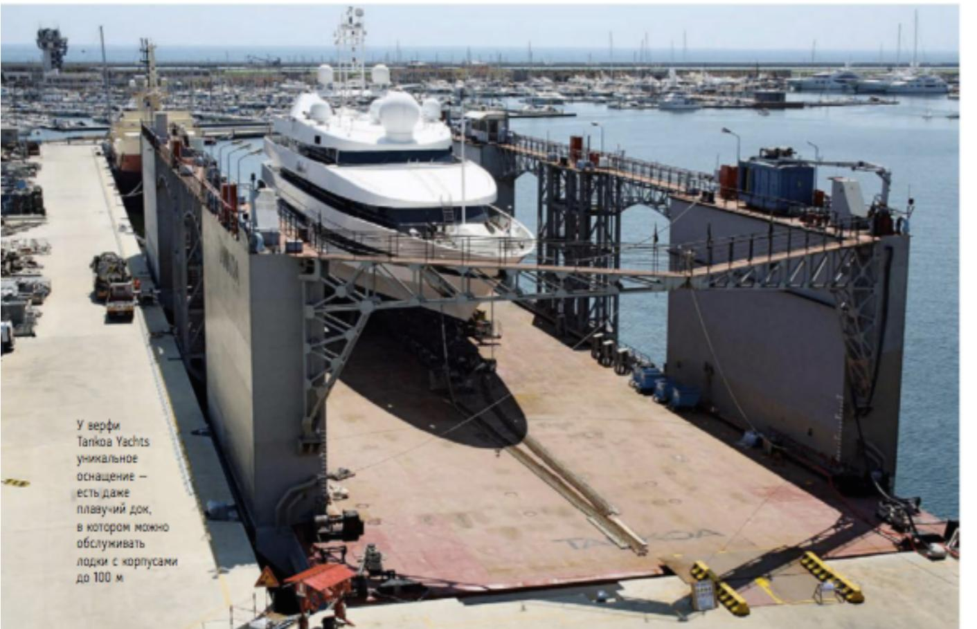
У верфи Tankoa Yachts уникальное оснащение — есть даже плавучий док, в котором можно обслуживать лодки с корпусами до 100 м
