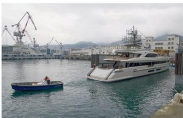
Первый корпус серии S50I итальянской бутик-верфи Tankoa – 50-метровая яхта *Vertige*, спущенная на воду в феврале, завершила свои первые морские испытания. Ей удалось превысить расчетную максимальную скорость 16 узлов, а уровень шума в каютах владельца на 12 узлах составил менее 50 dB, что сравнимо с шумом дождя за окном.
